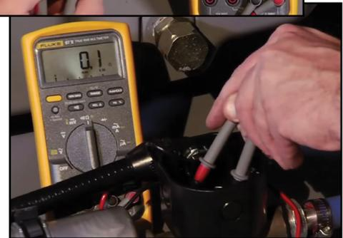
*Die Prüfung des Elements sowie der Durchgängigkeit des Thermostats erfolgt unter Einsatz eines Ohmmeters. Stellen Sie sicher, dass in einem aus mehreren Elementen bestehenden Heizsystem alle Komponenten überprüft werden.*
