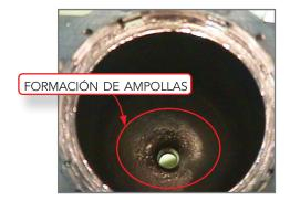
La formación de ampollas en el interior del tanque del calentador de termosifón es un signo que indica un problema de restricción de flujo. Si el refrigerante no puede circular de manera adecuada, puede sobrecalentar el tanque y, finalmente, causar la falla del elemento calentador.
