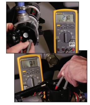
Se utiliza un óhmetro para probar el elemento y la continuidad del termostato. Asegúrese de probar todos los elementos de un sistema de calentamiento de elementos múltiples.
