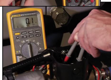
*Un ohmmètre est utilisé pour tester la continuité des éléments et du thermostat. Veiller à tester tous les éléments d'un préchauffeur à éléments multiples.*
