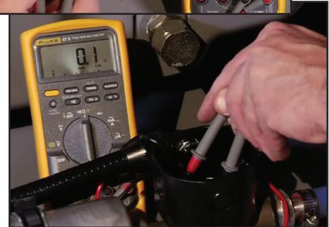
*O omímetro é usado para testar o componente e a continuidade elétrica do termostato. Certifique-se de testar todos os elementos em sistemas de aquecimento que contêm diversos Elementos.*
