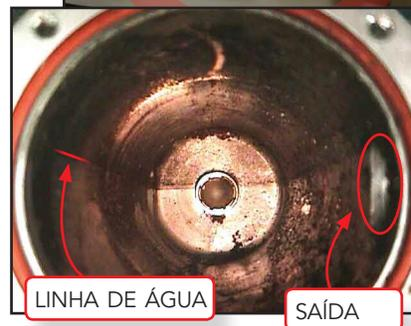
*Este aquecedor foi montado com a saída voltada para o lado. O fluido de arrefecimento nunca alcançou a parte superior do tanque. Isto expôs os elementos ao ar e eliminou a capacidade do aquecedor de "puxar" o fluido de arrefecimento frio do motor. É fundamental que o aquecedor sempre tenha a quantidade certa de fluido de arrefecimento armazenada no mesmo. Isto significa que, para funcionar corretamente, a saída deve estar no ponto mais elevado do aquecedor.*
