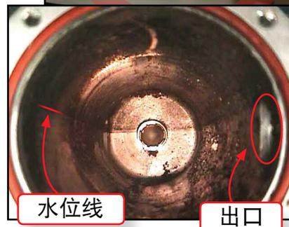
此加热器的安装使出口朝向侧面。冷却液从未达到过水箱的上部分。这样就使元件暴露在空气中并且使加热器无法从发动机“抽取”冷的冷却液。加热器在任何时候都充满冷却液至关重要。这意味着加热器的出口必须在加热器的最高点，才能使其正常工作。
