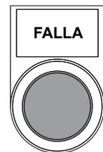
Figura 8. Luz de falla tal como aparece en la caja de control del OMM/OLM.
